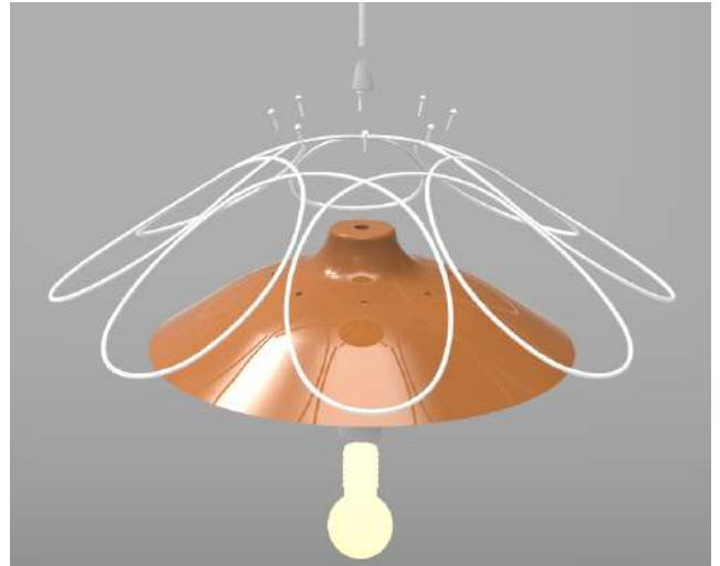
FIGURA 56 - Vista explodida da cúpula que indica onde serão encaixadas as peças.
